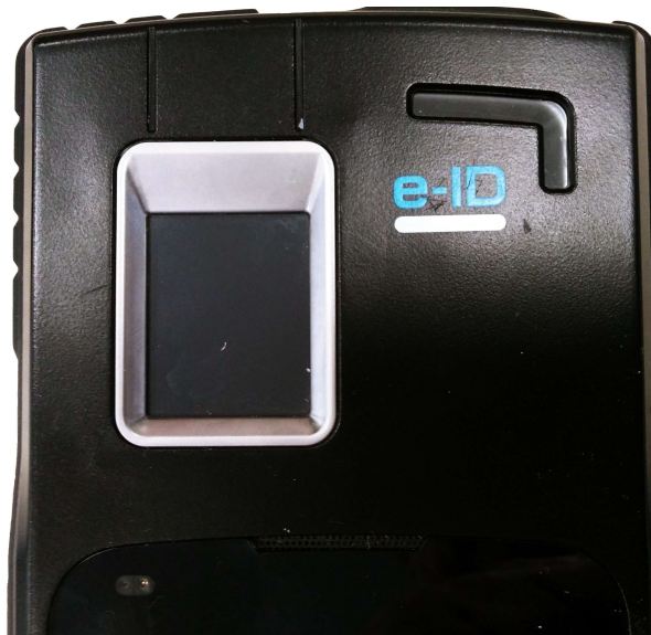
Рисунок 1.2 – Дактилоскопический сканер на лицевой стороне изделия
